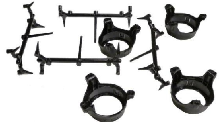
نگه می دارد. سیستم راهگاه عایق بندی شده تنها برای تعداد کمی از مواد پلاستیکی که دارای ساختمان نیمه کریستالی و علت ضریب هدایت گرمایی پایین هستند قابل استفاده است.
