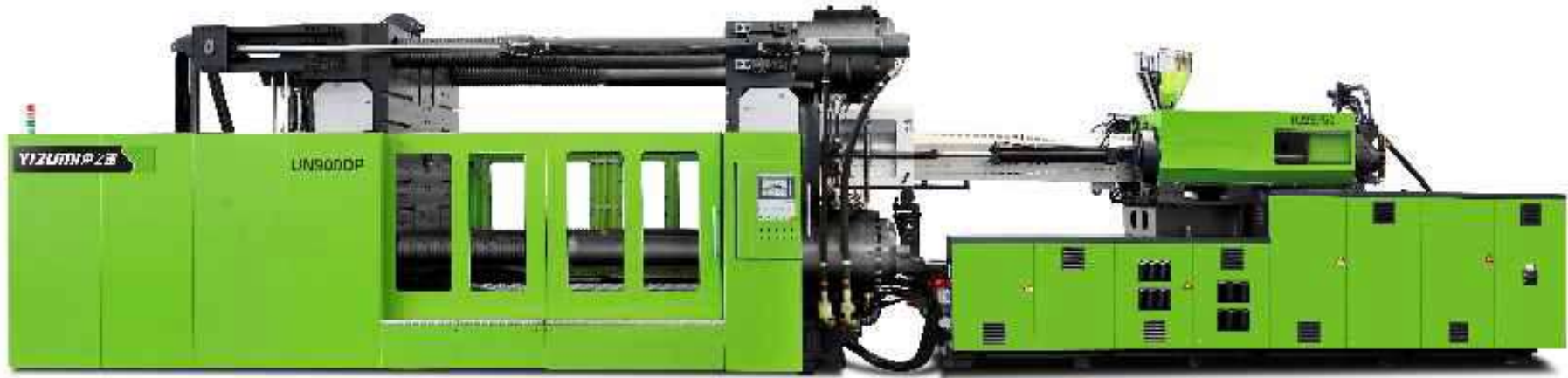
دستگاه تزریق پلاستیک دوصفحه‌ای UN900DP MultiPro-HM مجهز به صفحه گردان افقی و واحد تزریق ۲ رنگ
